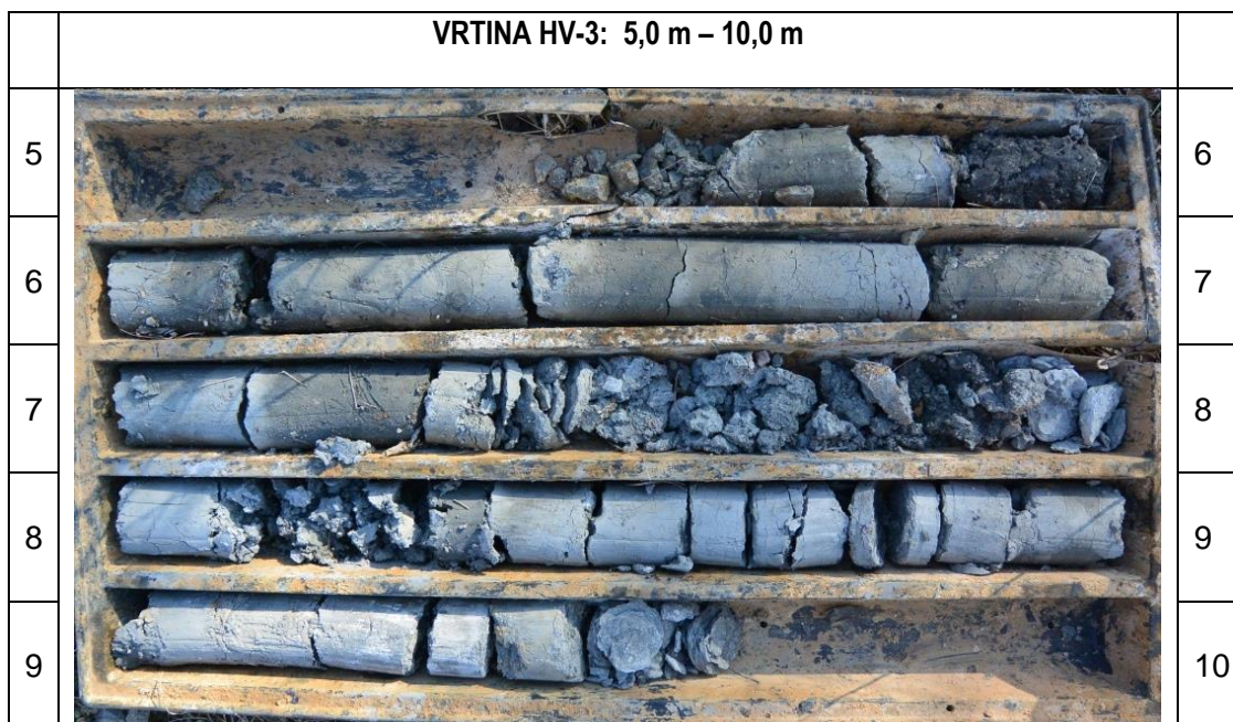
Slika 8,9: Geološka sestava vrtnice HV-3
